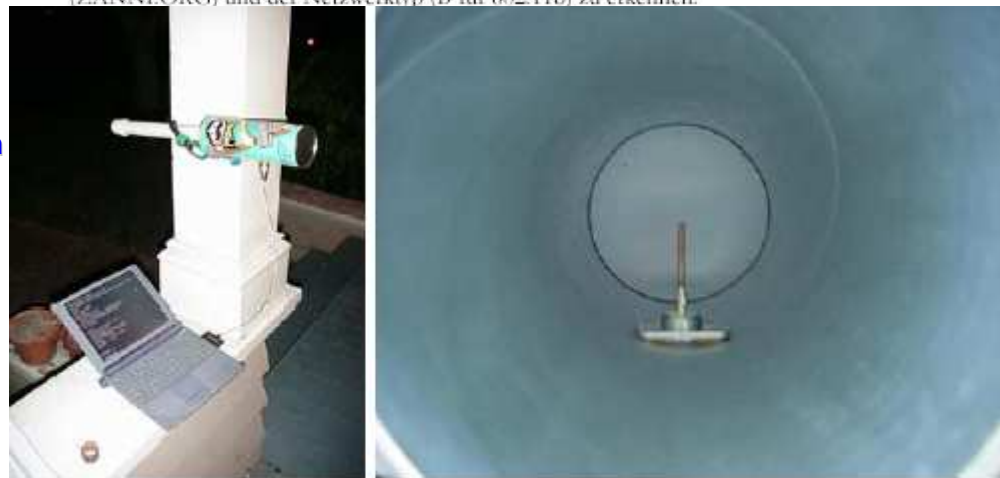
Abbildung 3: Selbstgebastelte Richtantenne aus einer Chipsdose. Links: Die ausgerichtete und an eine PCMCIA WLAN Karte angeschlossene Antenne. Rechts: Einblick in die Röhre, in die ein „Empfangsstift“ ragt.
