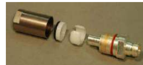
Las 4 partes del conector N-type
