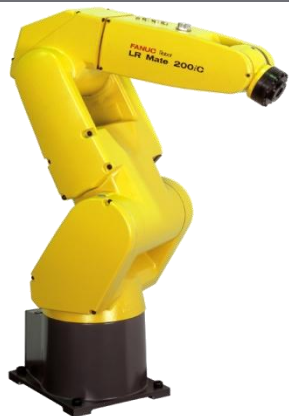
LR Mate 200iC 6 ejes - 5 kg R = 704 mm
