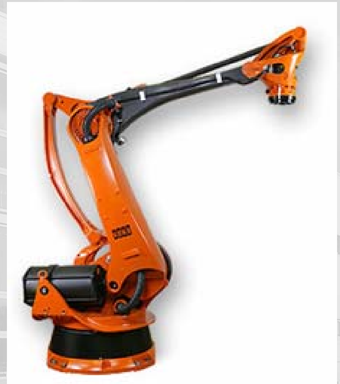
Ilustración 1. Robot KUKA KR 180 PA Artic
